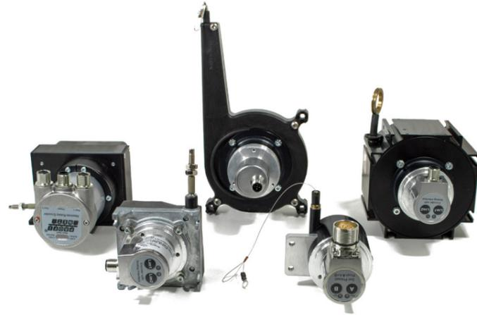
线性传感器，也称为拉线传感器，采用编码器来执行线性位置的测量，从而提供高精度检测。通过将编码器连接到拉线盒，编码器提供与拉出的线缆成比例的信号。齿轮和齿条方案通常需要完美的对齐和焊接，与之相比，拉线传感器提供了一个易于安装的方案，并且提供了多种接口选项。得益于强大的 UBIFAST 配置工具，POSITAL客户可以在按需选择测量范围后定义分辨率。因此，它可以满足任何涉及线性位移的应用。
