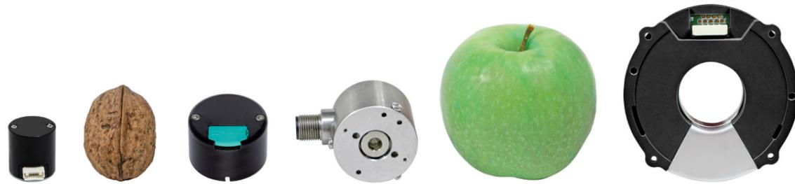
Kit编码器是模块化旋转编码器，没有整体滚珠轴承。其紧凑和经济的设计是集成到其他系统，如机器人系统，步进电机或伺服电机的理想选择。POSITAL的产品组合包括许多没有电池或齿轮的多圈版本。传感技术的融合产生了独特的设计，具有不间断的多圈计数功能，由韦根传感器提供动力。安装时不需要特殊设备。有各种机械配置，最小外径可选22毫米。增强的信号处理软件使高分辨率的位置测量具有优异的实时性能。
