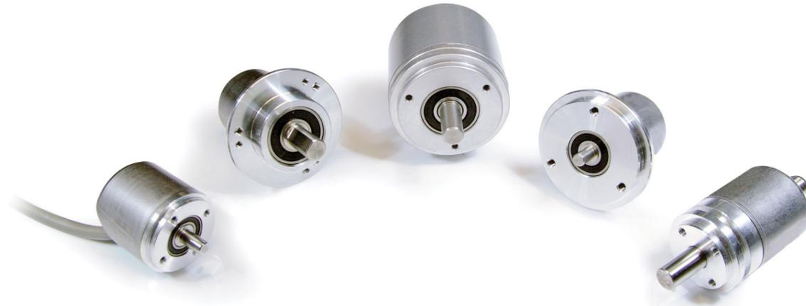
每次轴旋转一定角度时，增量型旋转编码器都会产生一个输出信号。每圈的信号（脉冲）数，也称为PPR，定义了设备的分辨率。增量型编码器的内部组件比绝对式编码器的内部组件简单得多。这满足了许多应用对简单、经济高效的解决方案的需求，同时仍能提供准确的定位。增量型旋转编码器支持HTL（推挽）或TTL（RS422）输出，可提供A,B,Z及其反向信号。POSITAL 磁性编码器均可通过 UBIFAST 配置工具进行配置：有助于降低库存水平。
