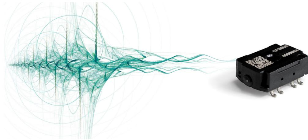
韦根传感器提供磁感应功能，无需施加任何外部电压或电流。传感器的材料特性意味着每次磁场极性转换都会产生一致的脉冲。除了磁感应之外，超低功耗电子元件还可以通过采集单个脉冲的能量来供电，或者存储连续脉冲来抵消电路的能量需求。
