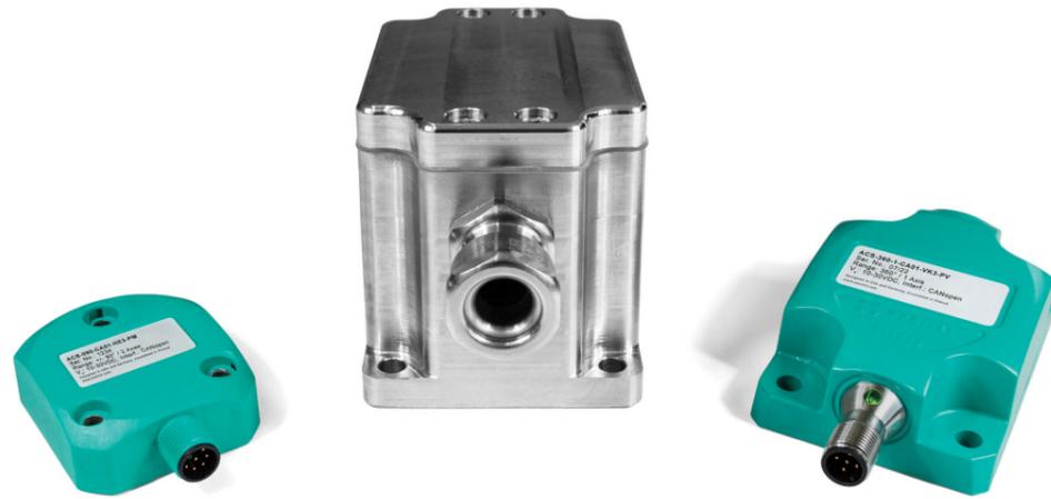
倾角仪，也称为倾斜传感器，旨在测量物体相对于重力的角度。这些倾斜或水平仪以重力为参考确定空间中的角度方向，并通过相应的电气接口输出值。倾角仪集成到应用中非常容易，因为除了安装倾角仪本身之外，不需要其他的机械连接——这对设计工程师来说是一个真正的优势。POSITAL的倾角仪产品组合为不同行业提供解决方案，以应对所有特定于应用的挑战。
